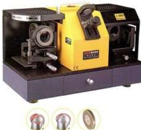
Станок MR-X8 предназначен для затачивания режущей кромки концевой радиусной фрезы. Станок является быстрым и точным, простым в применении, не требует особых навыков для затачивания.
