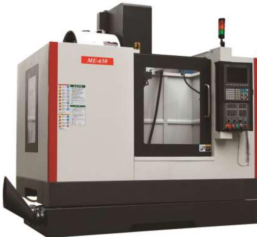
Вертикально-фрезерный обрабатывающий центр ME650 используется для фрезерования уступов, плоскостей и криволинейных поверхностей, а также для обработки отверстий концевым и расточным инструментом.
