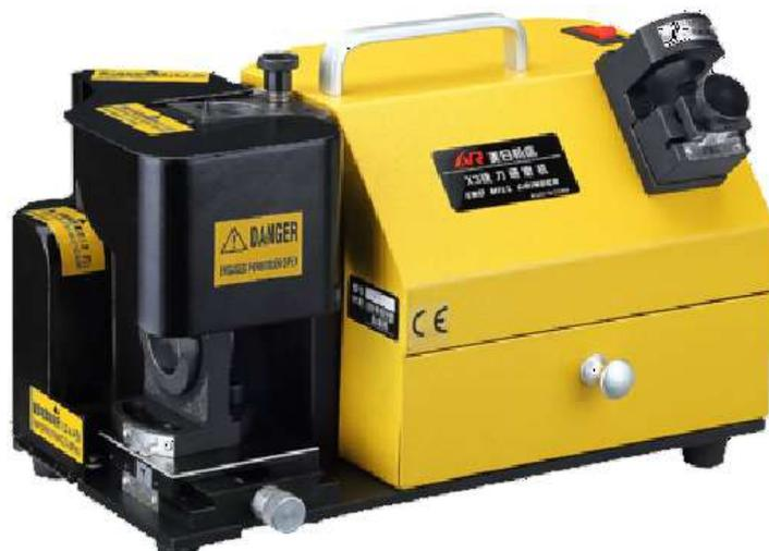
Станок MR-X3 предназначен для затачивания режущей кромки концевой фрезы (возможно затачивание 2 канавки, 3 канавки и 4 канавки), а также режущую кромку торцевой фрезы с 5 канавками (свыше  $\Phi 12$  мм может затачивать торцевую фрезу с 6 канавками). Также станок может открывать режущую кромку бурильной штанги из вольфрама. Станок является быстрым и точным, простым в применении, не требует особых навыков для затачивания.
