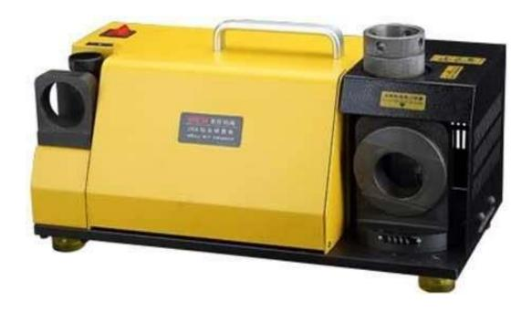
Станок MR-26A предназначен для затачивания передней поверхности режущей кромки сверла, заднего угла, перемычки с возможностью контроля угла заточки.
