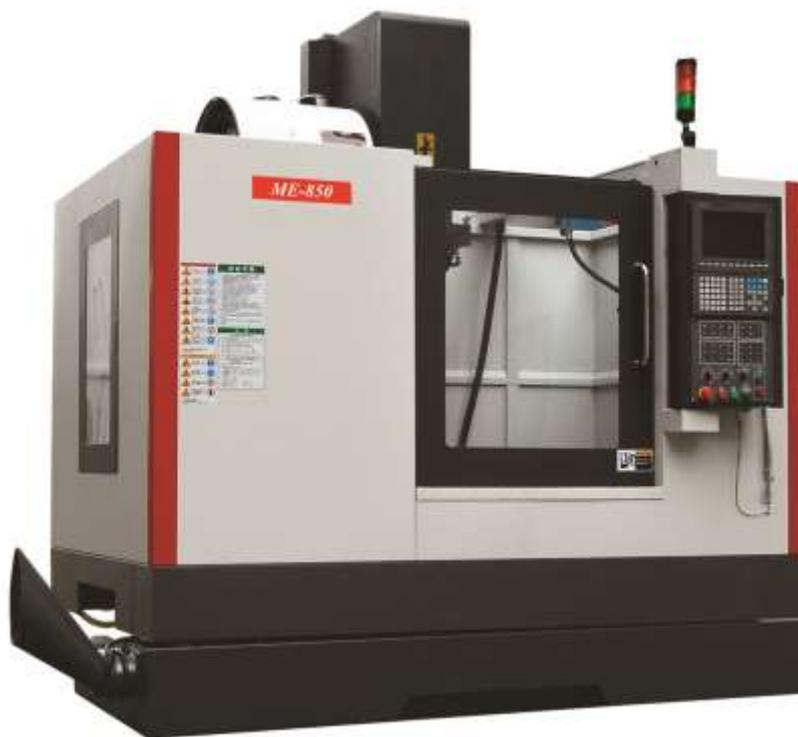
Вертикально-фрезерный обрабатывающий центр ME850 используется для фрезерования уступов, плоскостей и криволинейных поверхностей, а также для обработки отверстий концевым и расточным инструментом.
