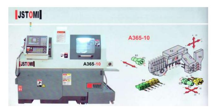
Токарные автоматы продольного точения с ЧПУ JSTOMI созданы для производительной токарно-фрезерной обработки мелких деталей из прутковой заготовки. Возможность автономной работы шпинделя и противошпинделя позволяет заметно сократить цикл обработки, увеличивая общую производительность на производстве.
